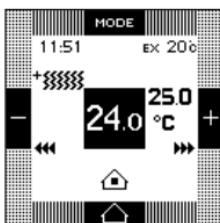
■ A tecla **MODE** permite seleccionar manualmente um dos níveis de temperaturas seguintes:
