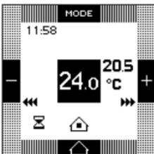
Pressões sucessivas na tecla permitem passar para o modo Conforto durante uma duração definida. O menu Temporização conforto permite regular a duração dessa temporização conforto.
