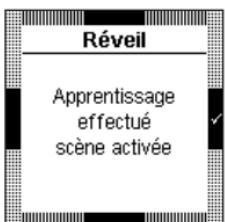
**⚠ Le numéro de la scène utilisé pour le réveil est celui configuré dans le TX100 ou dans ETS.**
