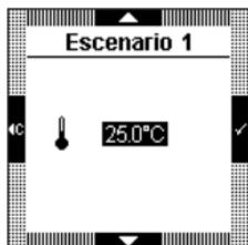
Si usted escoge la consigna temperatura
