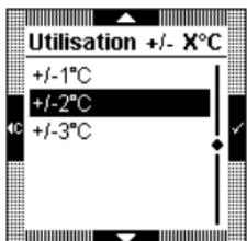
si le fonctionnement souhaité est "réglage dans une plage +/- X°C" :
