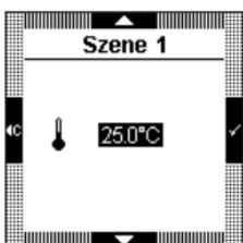
Wenn Sie Temperatur wählen, müssen Sie die gewünschte Temperatur **↓**, anschließend mit Hilfe der Tasten **▲** und **▼** einstellen.
