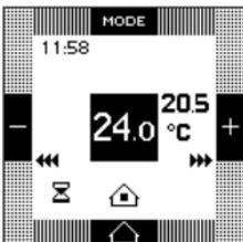
Flera succesiva tryckningar på tangenten ger möjlighet att växla till driftläge Komfort för en bestämd tidsintervall. Menyn Tidsfr komfort ger möjlighet att ställa in tidslängden på denna tidsfördröjning komfort.
