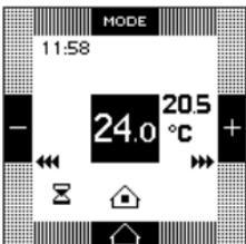
Presiones sucesivas sobre la tecla permiten cambiar al modo Confort durante una duración determinada.
