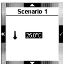
Se scegliete Temperatura , è necessario impostare in seguito il valore della temperatura voluta mediante i tasti **▲** e **▼**.
