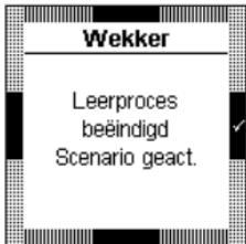
**Het voor de wekker gebruikte scenarionummer is het nummer dat werd geconfigureerd in de TX100 of de ETS.**
