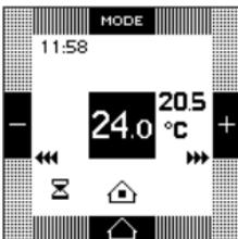
Des appuis successifs sur la touche permettent de basculer en mode Confort pour une durée définie.
