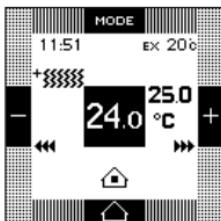
■ Die Taste **MODE** dient zur manuellen Auswahl eines der nachstehenden Temperatursollwerte:
