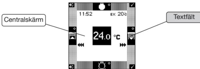
Tangentens funktion står angiven i tillhörande textfält.
