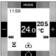
Durch mehrmaliges Betätigen der Taste gelangt man für eine bestimmte Dauer in den Anwesenheitsmodus (Komforttemperatur).
