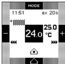
■ Il tasto **MODE** permette di selezionare manualmente una delle seguenti regolazioni:
