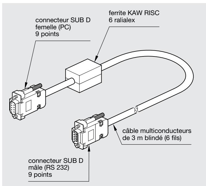
Il est possible de connecter bout à bout 2 câbles RS 232 pour obtenir une longueur maximale de 6 m. Ce montage est à utiliser avec précautions, car il n'est pas isolé de toutes perturbations électromagnétiques
