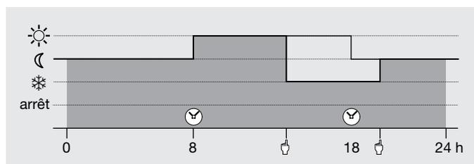
les consignes sont émises par le programmeur annuel et le forçage provient lui d'un actionneur simple (ex : supervision). Lorsque le forçage est annulé, le produit retourne sur le profil en cours. Un forçage est prioritaire devant un profil de base. Si un forçage provient de plusieurs sources, c'est le dernier arrivé qui sera interprété.
