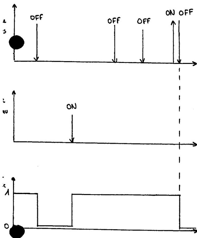
Le paramètre « comportement sur coupure bus ou secteur » est paramétré à ON. Une commande manuelle à OFF est passée. Si une coupure bus intervient, les sorties ne basculeront pas à ON.
